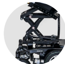
Elektrische Sitzkantelung mit optionalem 300 mm Scherenlift
