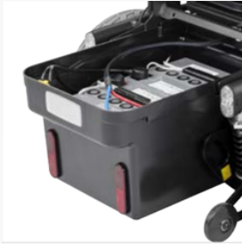
Servicefreundlichkeit: Einfache Batteriewartung durch ausziehbaren Batteriekasten
