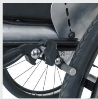
Bremse perfekt an jede Radposi-tion anpassbar
